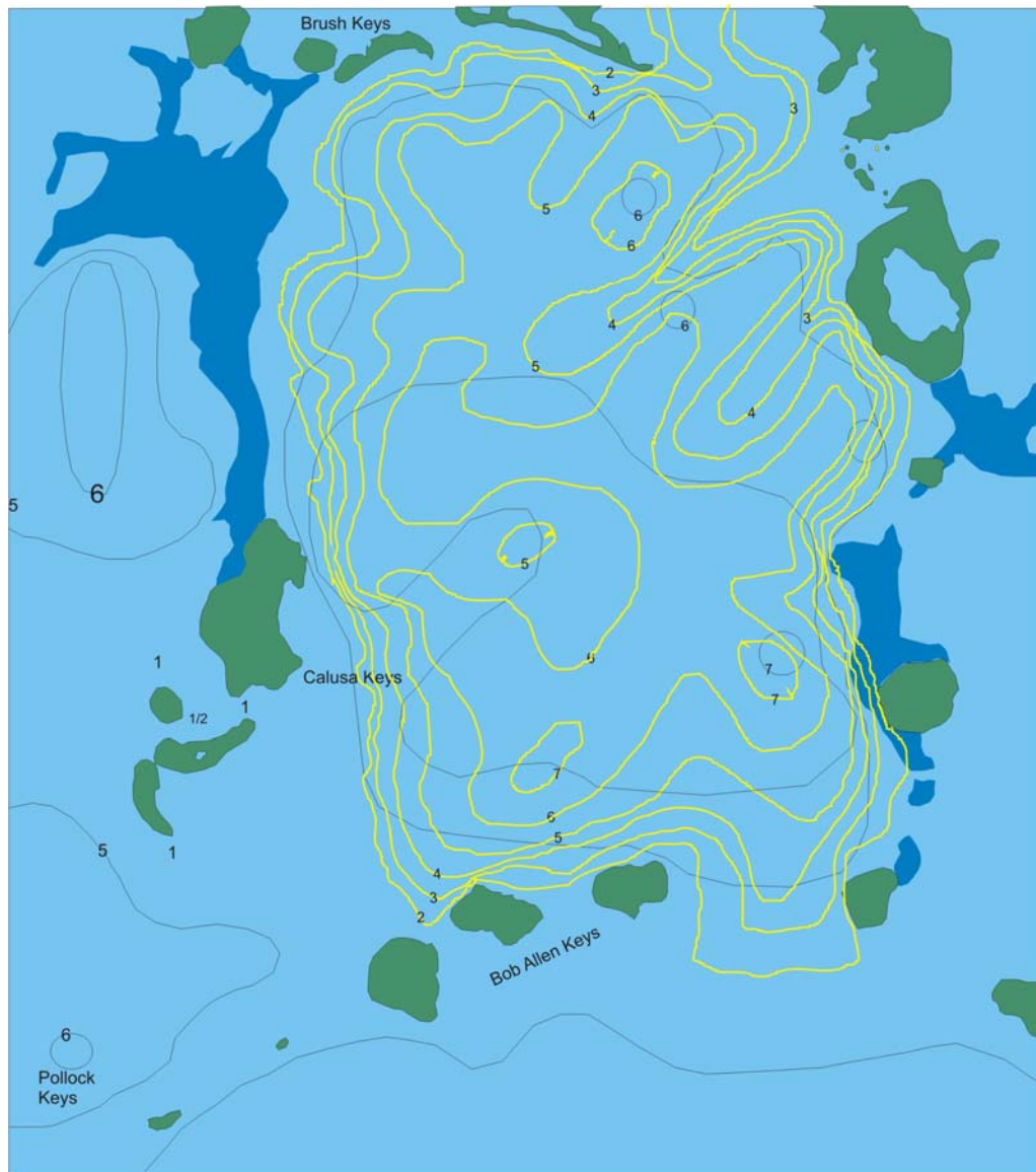
Рис.9. Уточненная с помощью оптических изображений батиметрическая карта участка Флоридского залива:
