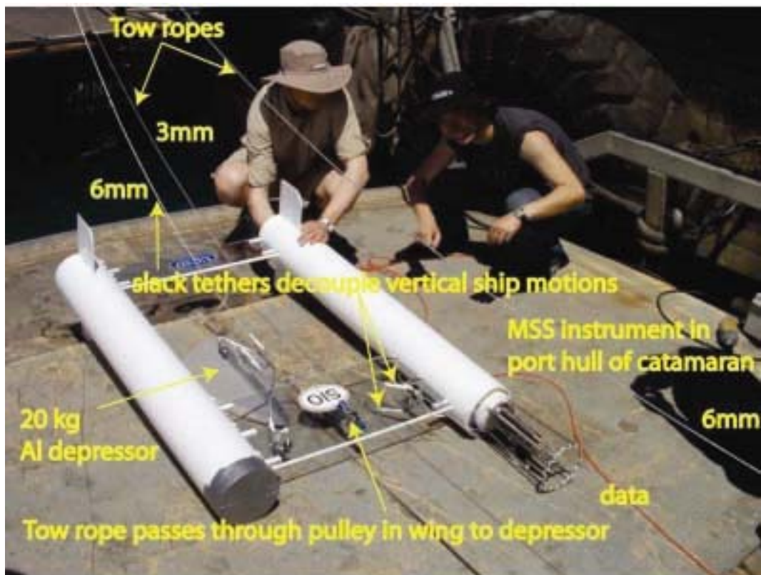
Рис.13. Установка MSS оборудования на корпусе катамарана. Допустимый максимум скорости в 2 м/сек превышался, но сенсоры температуры, проводимости и плотности были действующими.
